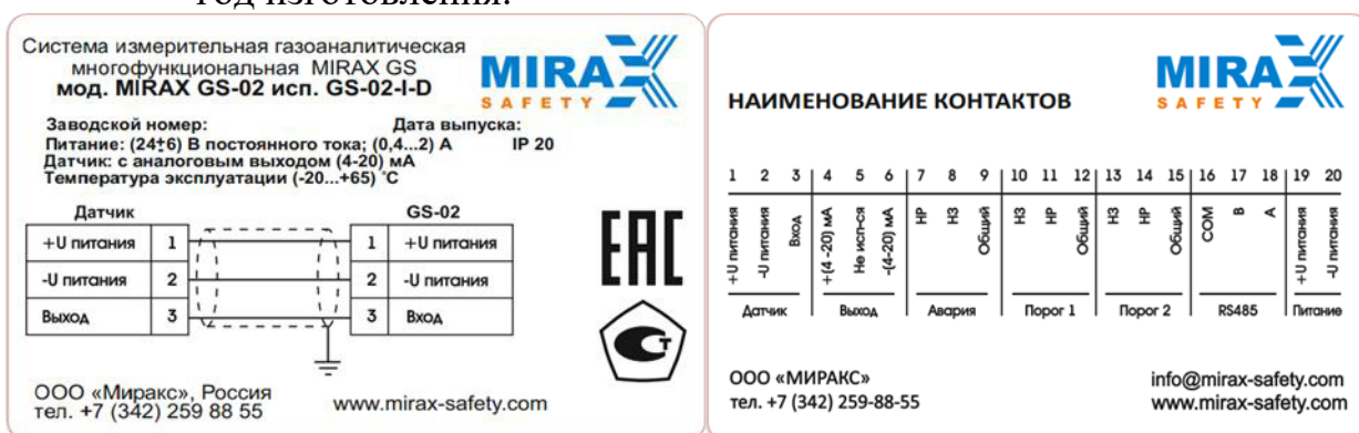
Рисунок 2 – Боковые наклейки контроллера
